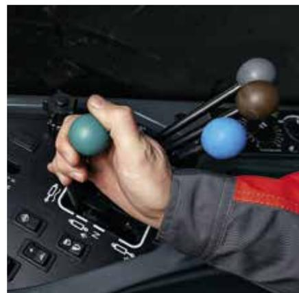
**Рычаги управления** удобно расположены на боковой консоли, что упрощает эксплуатацию и обслуживание трактора Ростсельмаш. Под каждым из рычагов имеется трехпозиционный фиксатор, что позволяет легко выбрать и зафиксировать нужную для работы настройку.
