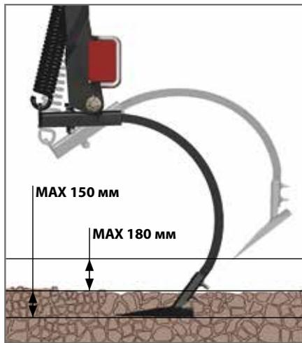
**Удобные регулировки рамы** обеспечивают выравнивание как в продольном, так и в поперечном направлении. Высота подъема стрелчатой лапы – 180 мм над землей.
