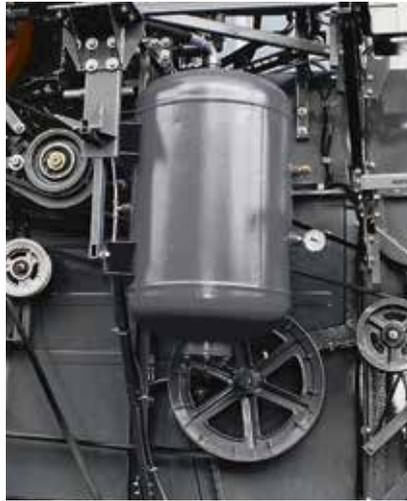
**Воздушный компрессор** экономит немало времени на ежесменное обслуживание, особенно в мобильных условиях при отсутствии машины технической поддержки. Компрессор включен в базовую комплектацию – так компания Ростсельмаш ввела новые отраслевые стандарты.
