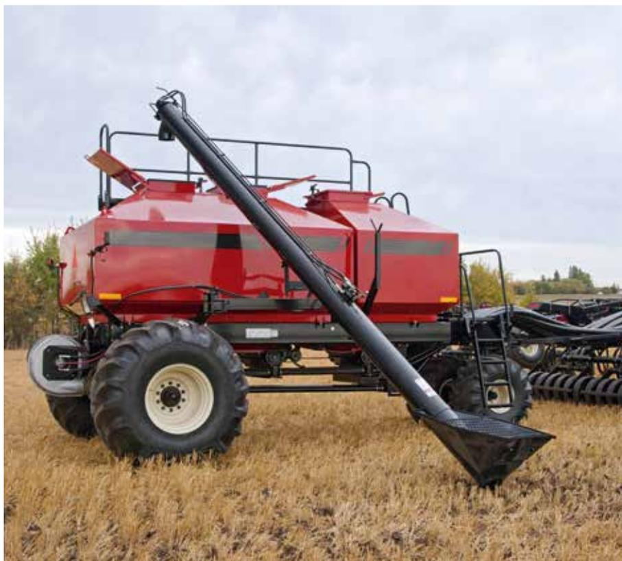
Стандартный для всех моделей бункеров загрузочный шнек диаметром 213 мм обеспечивает быструю загрузку семян и удобрений в резервуары, а удачная конструкция воронки позволяет загружать семена наиболее комфортно, без разбрасывания их по сторонам при вращении шнека.
