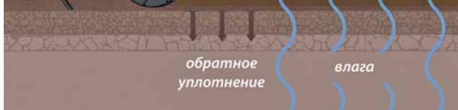
**Пассивный режим** применяется в случаях, когда необходимо спровоцировать активное прорастание сорняков при обработке паров или предпосевной подготовке почвы. За счет обратного уплотнения почвы, возникающего благодаря эффекту «прижима», ускоряется формирование капиллярных связей между глубоким и поверхностным слоями почвы.
