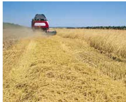
**Высокое качество соломы.** Сепарирующая часть ротора имеет шнековую навивку. Благодаря этому TORUM, в отличие от обычных роторных комбайнов, очень бережно обращается с соломой.
