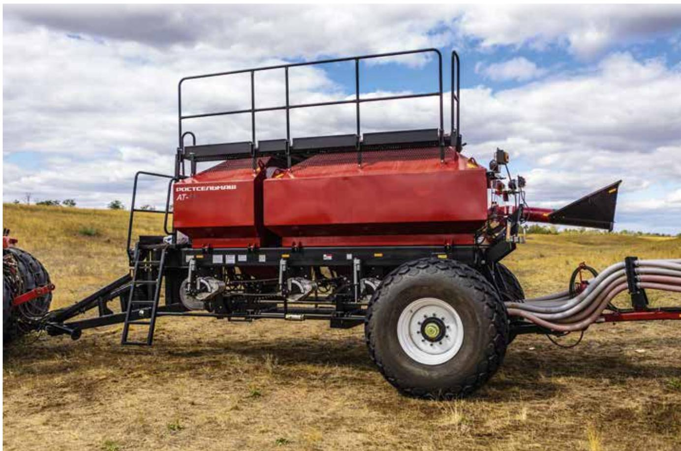
Бункер пневматический АТ-8, АТ-11 является необходимой частью посевного комплекса, которая отвечает за калибровку, поддержание постоянной нормы высева семян и удобрений независимо от скорости трактора, а также доставляет семена и удобрения по семяпроводам к сошникам. Пневматический бункер-раздатчик семян и удобрений отличается своей универсальностью, подходит для всех посевных комплексов производства Ростсельмаш.
