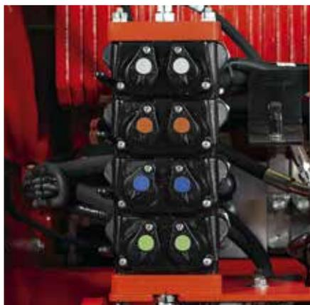
**Четкая маркировка соединительных муфт**, расположенная в задней части трактора, выполнена в соответствии с цветом рычагов контроля, установленных в кабине.
