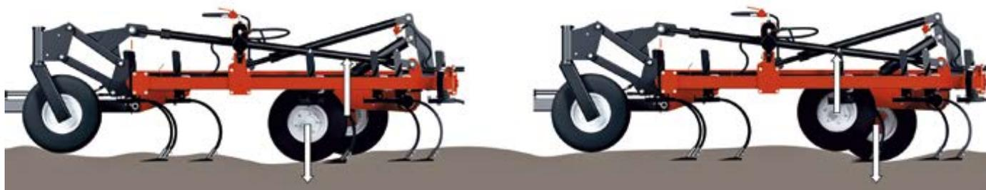
Сдвоенные балансирующие колеса обеспечивают плавный ход культиватора, особенно при движении поперек борозды. Копирование рельефа поля до 10° осуществляется благодаря шарнирному соединению крыльев, при этом увеличенная колесная база культиватора стабилизирует ход стрелчатых лап.
