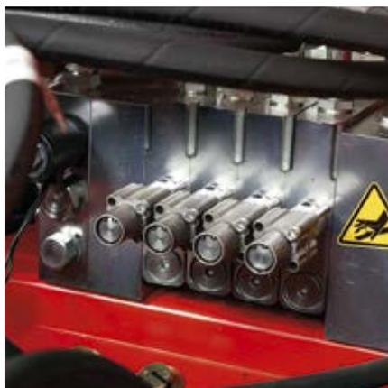
**Гидравлическая система** с приводом от тандема насосов (шестеренного и аксиального), с изменяемой производительностью в зависимости от нагрузки, обеспечивает регулировку и подачу давления по необходимости. Отдельный контур рулевого управления с клапаном приоритета обеспечивает стабильную подачу давления, не прерываемого прицепным оборудованием. Если рулевое управление не используется, дополнительная мощность направляется в основную систему агрегата.
