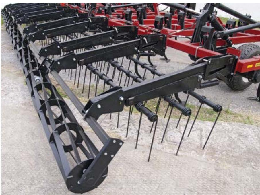
**Комбинированный шлейф культиватора**, состоящий из трехрядных пружинных борон и катка с активными планками, производит выравнивание поверхности поля. Пружинный механизм догрузки (от 40 до 80 кг) и возможность изменения углов установки пружинных зубьев особенно эффективны при вычесывании и выносе на поверхность поля корневой системы сорной растительности.
