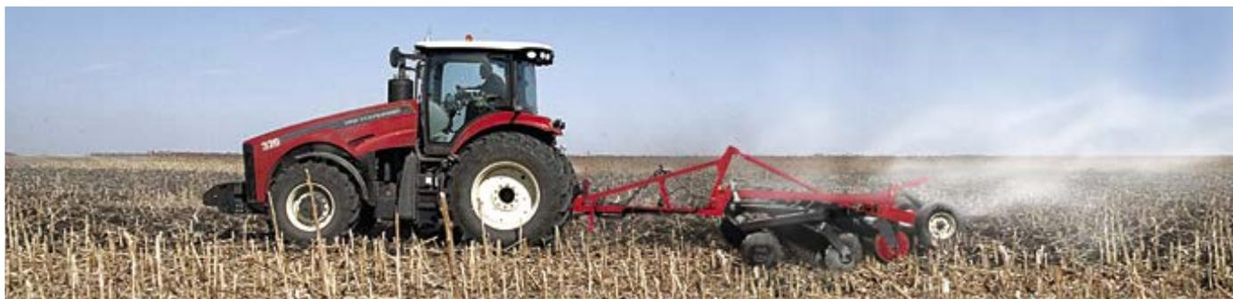
Борона-мульчировщик HD предназначена для поверхностной и предпосевной обработки почвы, измельчения пожнивных и растительных остатков, заделки удобрений.
