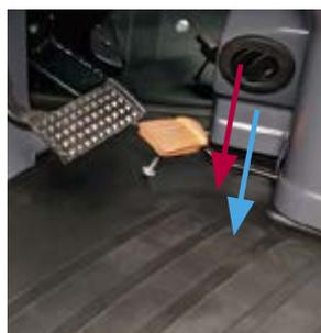
**Воздушный поток** из кондиционера или печки регулируется одиннадцатью дефлекторами, расположенными сверху и снизу кабины, что позволяет эффективно регулировать температуру в кабине.
