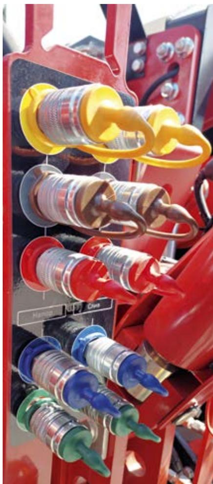
**Четкая маркировка соединительных муфт**, расположенная в задней части трактора, выполнена в соответствии с цветом кулис контроля, установленных в кабине. Удобное для оператора расположение соединительных муфт позволяет легко подсоединять оборудование. Это значительно экономит время, необходимое для рабочих процессов, в разгар полевой страды.
