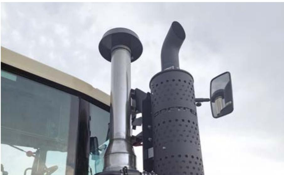
Благодаря высоко поднятой **трубе воздухозаборника** и принудительному удалению пыли из воздуха перед его попаданием в **воздушный фильтр** в двигатель поступает максимально очищенный от частиц воздух, что благотворно влияет на его работу и долговечность.
