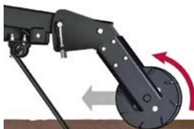
**Пассивный режим** применяется в случаях, когда необходимо спровоцировать активное прорастание сорняков при обработке паров или предпосевной подготовке почвы. За счет обратного уплотнения почвы, возникающего благодаря эффекту «прижима», ускоряется формирование капиллярных связей между глубоким и поверхностным слоями почвы.
