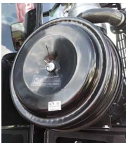
**Воздушный фильтр** двигателя удобно расположен для периодического обслуживания, своевременность которого позволяет предотвратить быстрый износ двигателя в тяжелых условиях работы.
