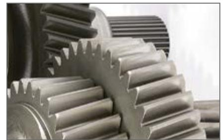
**Косозубые передачи** создают больший контакт между зубцами, что обеспечивает более надежную передачу мощности, плавное переключение и сокращает шум трансмиссии.
