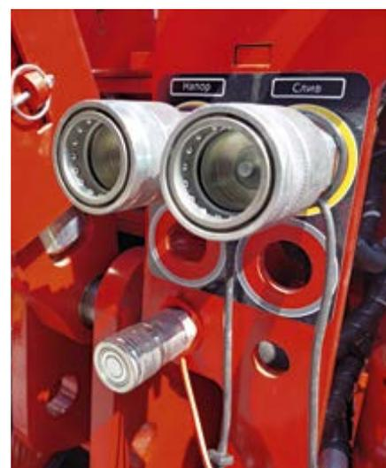
**Комплект Power Beyond** (опция) требуется для обеспечения нормальной работы некоторых посевных комплексов (например, с гидроприводом высевача бункера или автоматически подруливающих колес сеялки). Функция Power Beyond обеспечивает максимальный гидравлический поток от гидравлического насоса напрямую к потребителю (к сеялке), минуя гидравлический распределитель. Включает в себя пару муфт 1 дюйм и муфту для линии LS.
