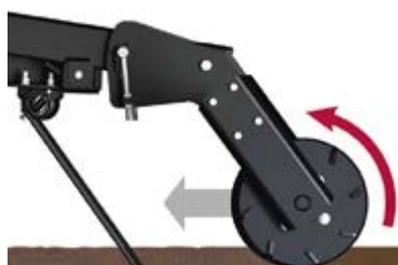
**РАСПОЛОЖЕННЫЕ ПОД УГЛОМ ПЛАНКИ КАТКА ПОЗВОЛЯЮТ ИСПОЛЬЗОВАТЬ КУЛЬТИВАТОР В ДВУХ РЕЖИМАХ ФИНИШНОГО ПРИКАТЫВАНИЯ: АКТИВНОМ И ПАСИВНОМ**
