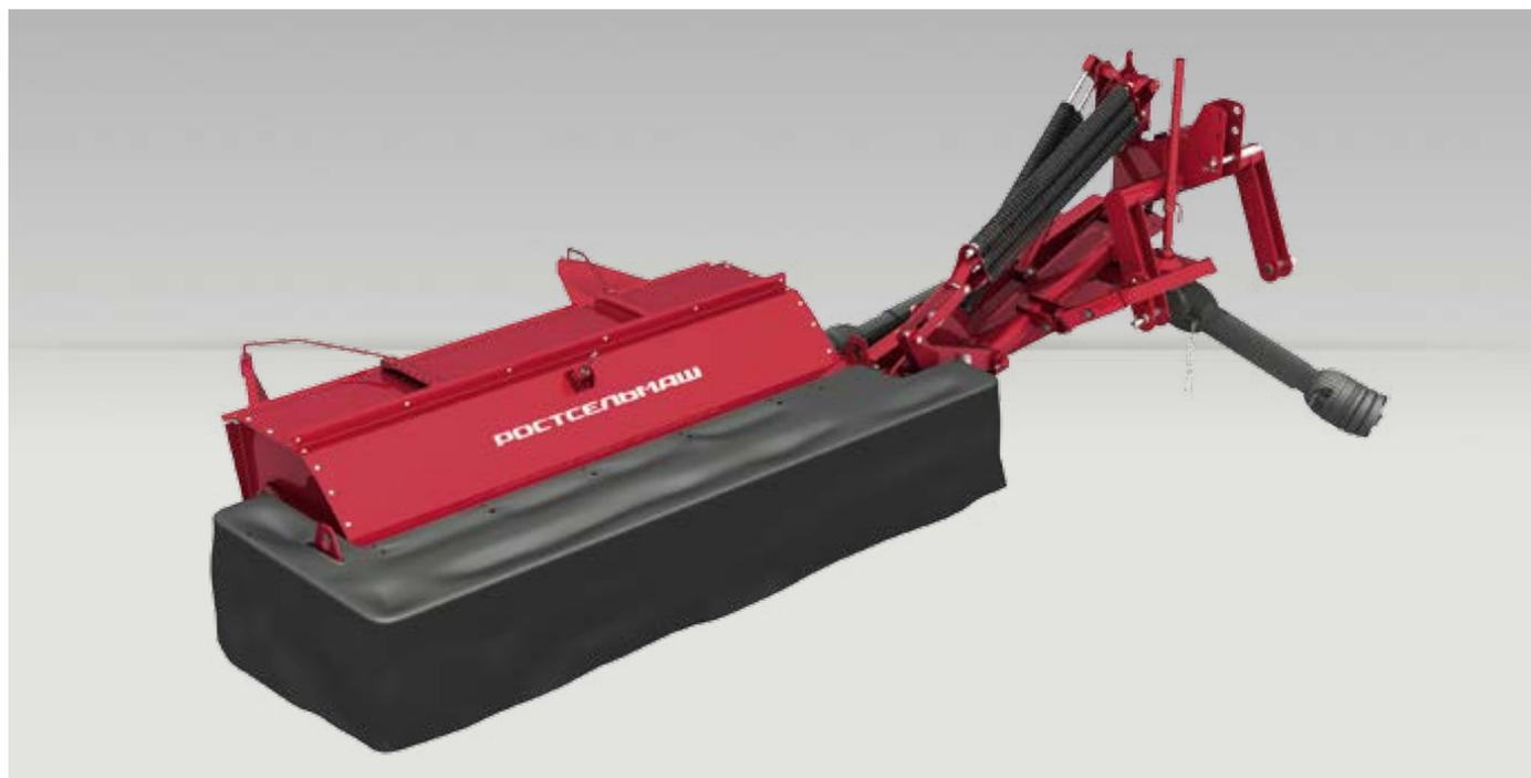
Косилка роторная с кондиционером SAPSUN 2400 поможет добиться образцового качества сена. Она создана для работы с высокоурожайными и полеглими травами. На повышенных поступательных скоростях – до 15 км/ч – машина чисто скашивает, без труда вспушивает и укладывает массу в равномерный валок.
